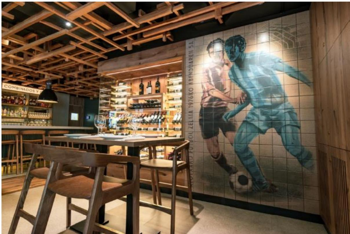
Sublime, la società del Gruppo Concord di Maiorca, incaricata di progettare i murales, spiega il processo di sublimazione eseguito su HI-MACS®; si tratta di una tecnica complessa, mediante la quale **le stampe digitali sono state trasferite allo stato gassoso sul materiale Solid Surface**, applicando una pressione e un calore controllati all'interno di forni speciali.
