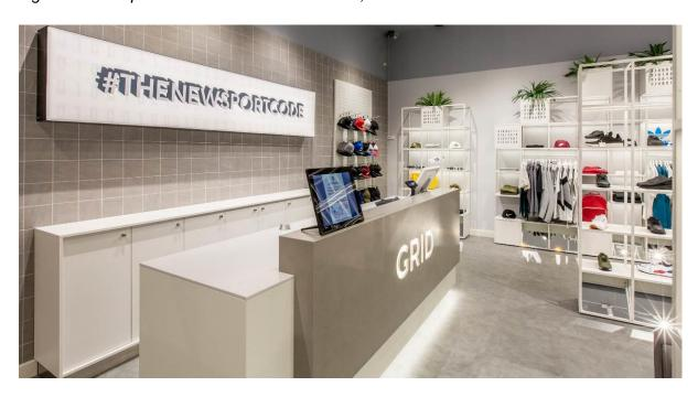
Le magasin révèle une structure composée de cubes de métal fixés les uns aux autres qui forment la « matrice binaire » imaginée par PickTwo. Fabriquées en acier recouvert d'une peinture par procédé électrostatique, toutes les étagères sont éclairées par des bandes LED blanches pour mettre en valeur les articles exposés. Au fond du magasin, des banquettes confortables invitent les clients à essayer les sneakers et autres collections de chaussures.
