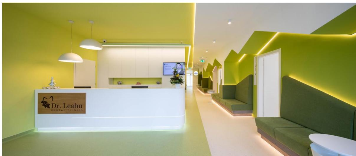
Per gli architetti di studio3plus, la scelta si è basata sulle eccellenti proprietà del materiale: la sua termoformabilità e **la superficie completamente liscia, non porosa e priva di giunti**, rendono questo Solid Surface perfetto nel contesto di un ambiente sanitario. Grazie alla sua uniformità, HI-MACS® è **estremamente igienico e ideale per l'uso in ambienti medici**, oltre che facile nella pulizia e manutenzione.
