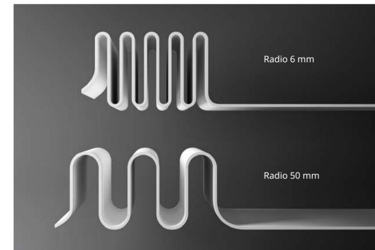
Se puede dar forma a las placas de HIMACS Ultra incluso con una mayor facilidad: el radio interior mínimo de 6 mm (frente a los 50 mm tradicionales) ofrece unas dimensiones de diseño completamente nuevas. Un 30 % más de flexibilidad permite al diseñador crear unas curvas mucho más pronunciadas. Se pueden lograr hasta los radios más pequeños sin que esto afecte a las propiedades del material.
