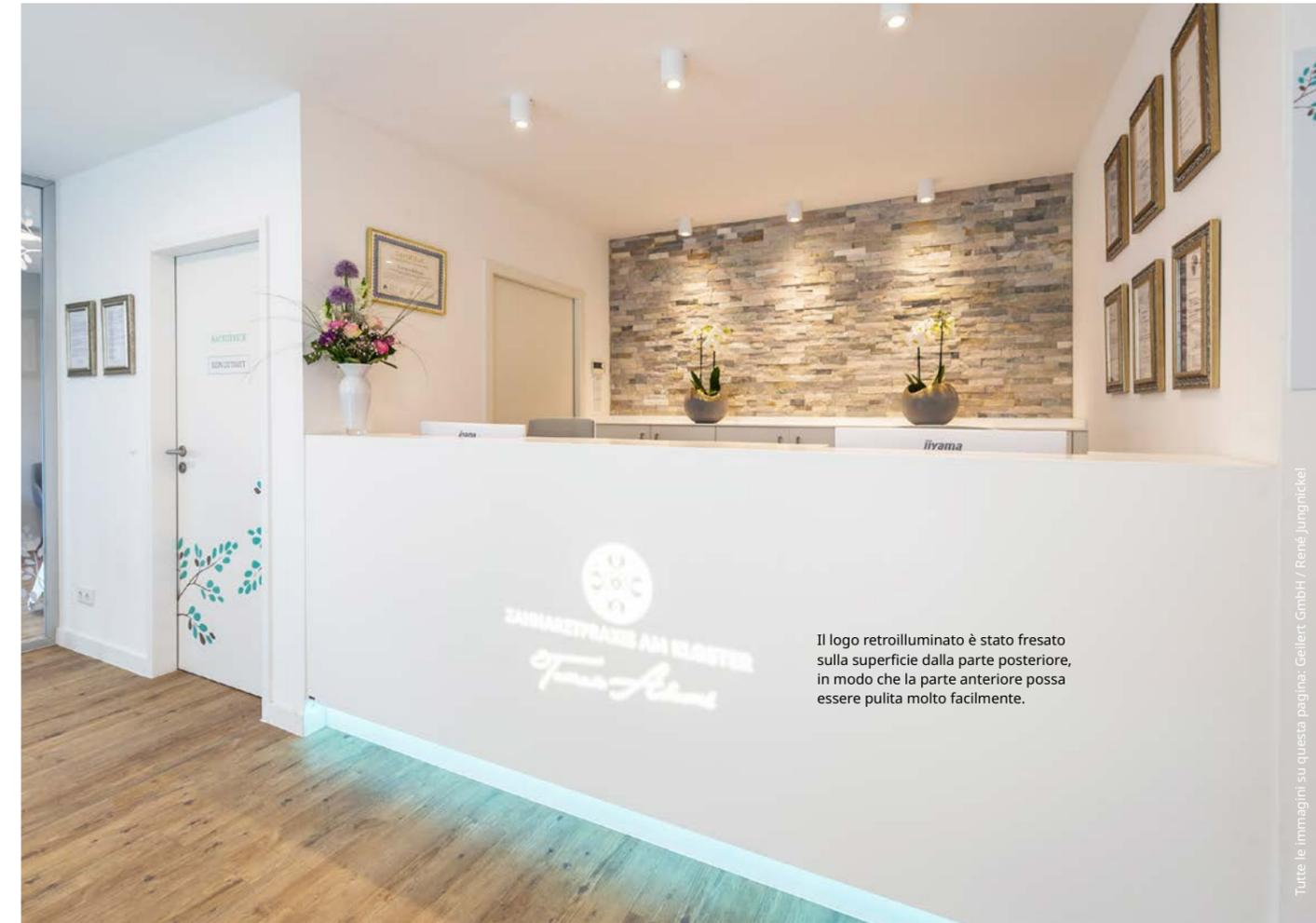
Il logo retroilluminato è stato fresato sulla superficie dalla parte posteriore, in modo che la parte anteriore possa essere pulita molto facilmente.
